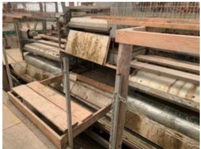
(d) Manure belt mechanism.
