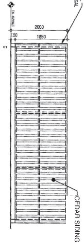
3B Garbage Enclosure Elevation PT 2 SCALE: 1:50
